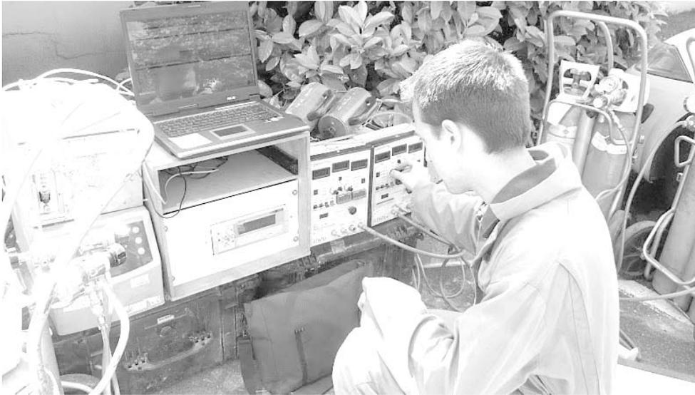
Installation du matériel en vue d'un prélèvement de rejet atmosphérique
